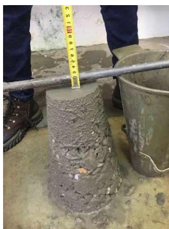
Figura 12 – Abatimento para substituição com 5% do pó da pedra Morisca [Autoria Própria]
