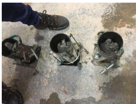
Figura 6 – Moldagem de corpo de prova [Autoria própria]
