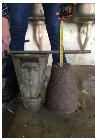
Figura 14 – Abatimento para substituição com 10% do pó da pedra Morisca [Autoria Própria]
