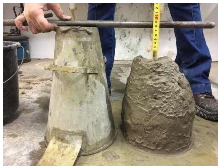
Figura 15 – Abatimento para substituição com 12,5% do pó da pedra Morisca [Autoria própria]
