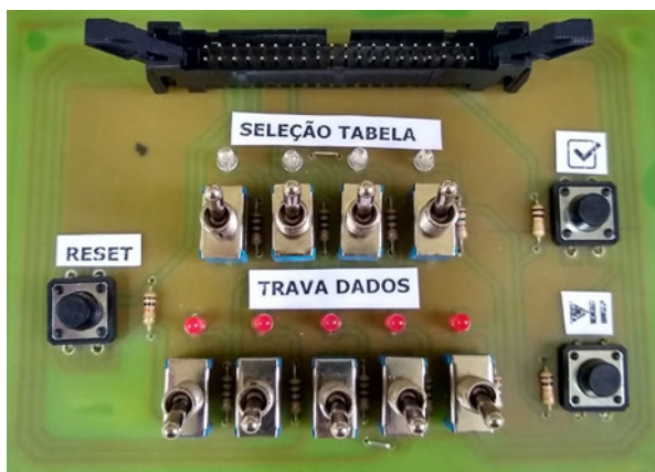
Figura 4 - Placa responsável pela comunicação dos jogadores com a máquina Fonte: Elaborado pelos autores
