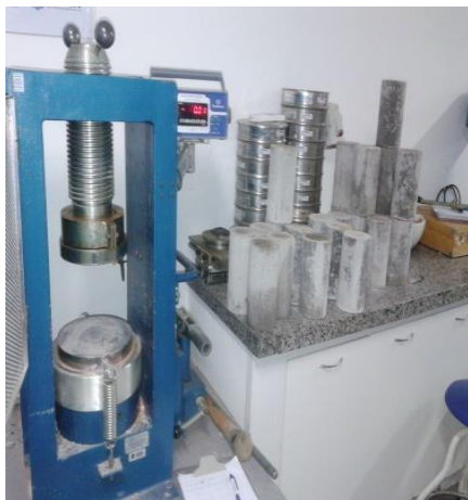
Figura 5: Prensa hidráulica elétrica.
