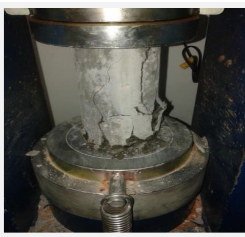
Figura 6: Corpo de prova sendo comprimido.
